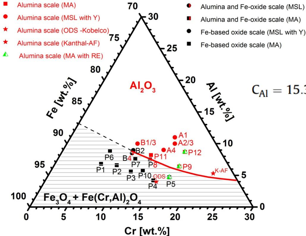
$$C_{Al} = 15.3 - 0.81(C_{Cr}) + 0.0156(C_{Cr})^2 \text{ [wt.\%]}$$
