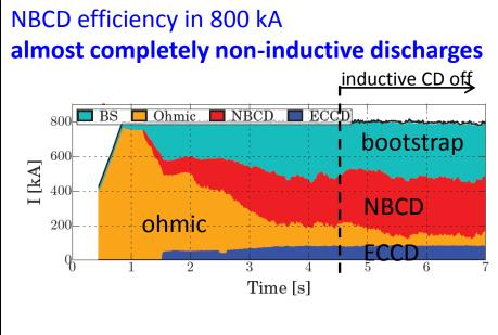
$P_{\rm NBI} = 12.5 \text{ MW}$  $P_{\rm ECRH} = 2.8 \text{ MW}$  $q_{\rm min} > 1.5, q_{95} = 5.5$  $\beta_{\rm N} \approx 2.5, H_{98} \approx 1$
