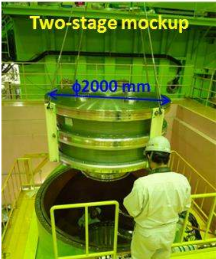
【Mockup test of HV bushing】
