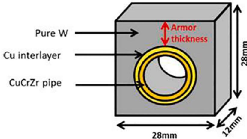
Fig. 1. ITER tungsten divertor monoblock scheme [3].
