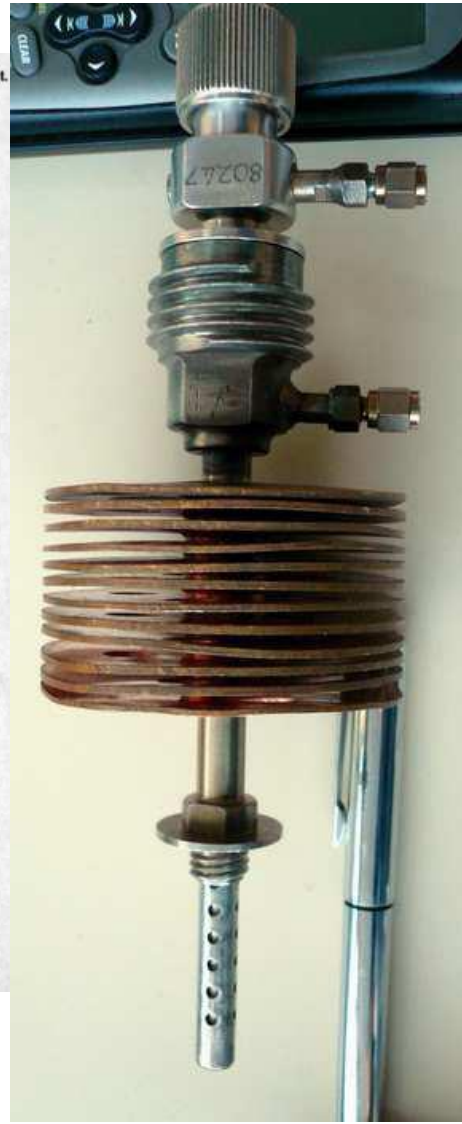
Sonde de mesure HARWELL type MK IIA [1] : corps mécanique de montage sur circuit.
