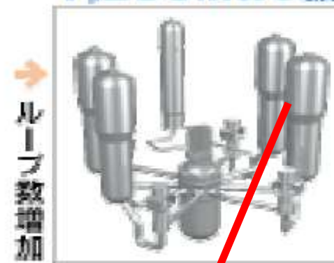
4ループ 1,200MWe級
