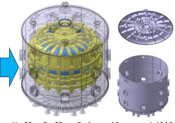
H  $\sim$  29 m, D  $\sim$  38 m , Background Pressure  $\sim$  1x10<sup>-4</sup> Pa
