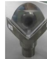
A: tungsten retro-reflector on first wall
